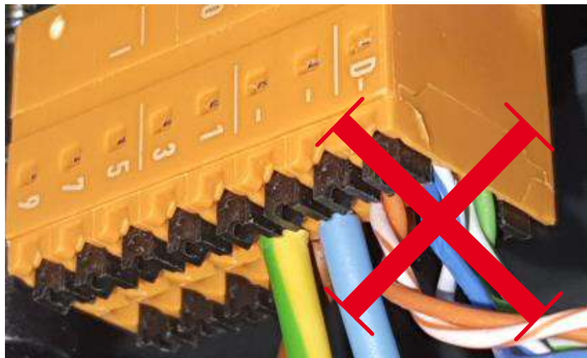
Par trenzado para D+ y D- (Cat 5 o superior)
